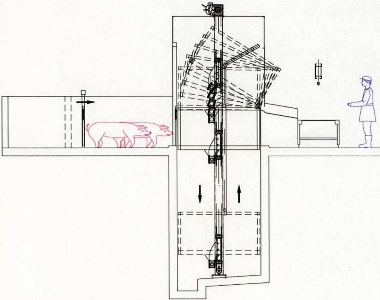
Principe : Système travaillant par pallier
