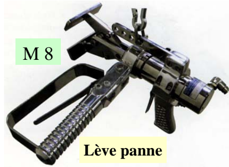
Coupe cornes hydraulique à lames incurvée
